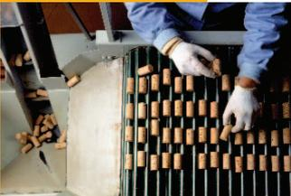
Également désigné sous le terme de triage, la sélection est l'opération destinée à séparer les bouchons en différentes catégories (de 0 à 6 selon la Charte des Bouchonniers-Liégeurs) par classes visuelles différenciées. La détermination de chaque classe est faite par un contrôle automatique de la surface des bouchons en fonction de la quantité de lenticelles (pores de surface) présentes en surface. La sélection se fait également par triage visuel ou automatique.
