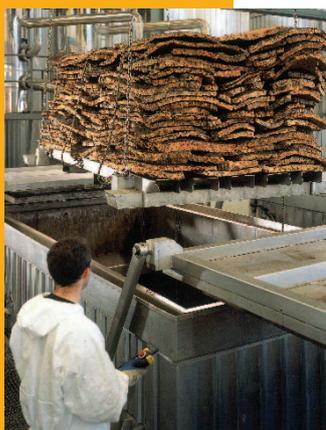
Le bouillage des planches est l'une des étapes les plus importantes de la phase de préparation du liège. Les planches sont plongées dans de l'eau propre en ébullition pendant une heure minimum. L'objectif est :
