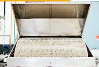
Après la rectification des bouchons, on procède à leur lavage, en utilisant généralement de l'eau oxygénée ou de l'acide peracétique. Ce bain sert à nettoyer et à désinfecter les bouchons. Certains industriels recourent à des méthodes complémentaires comme l'utilisation de micro-onde ou d'ozone.
